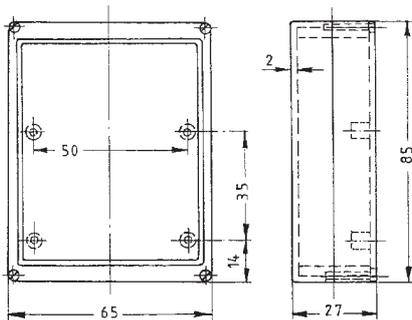
Kunststoffgehäuse aus antistatischem ABS-Kunststoff, bestehend aus einer Halbschale mit außengenarbttem Ober- und Unterteil
