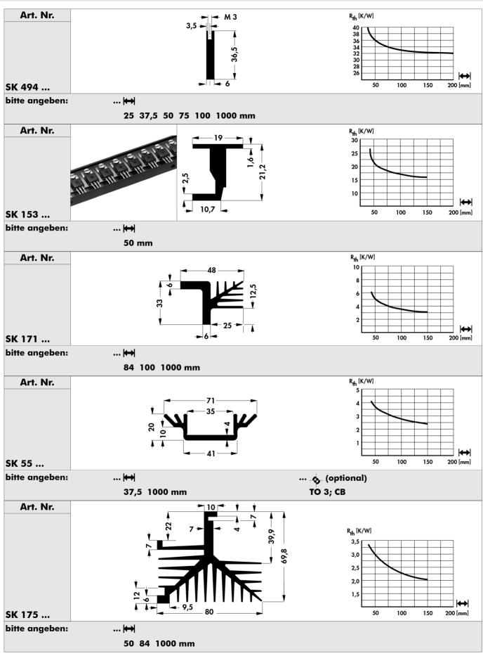
Montagewinkel für TO 3 Aufsetzkühlkörper für TO-Gehäuse Profile für Leiterkartenbauteile Kühlkörper mit Gewindestreifen
